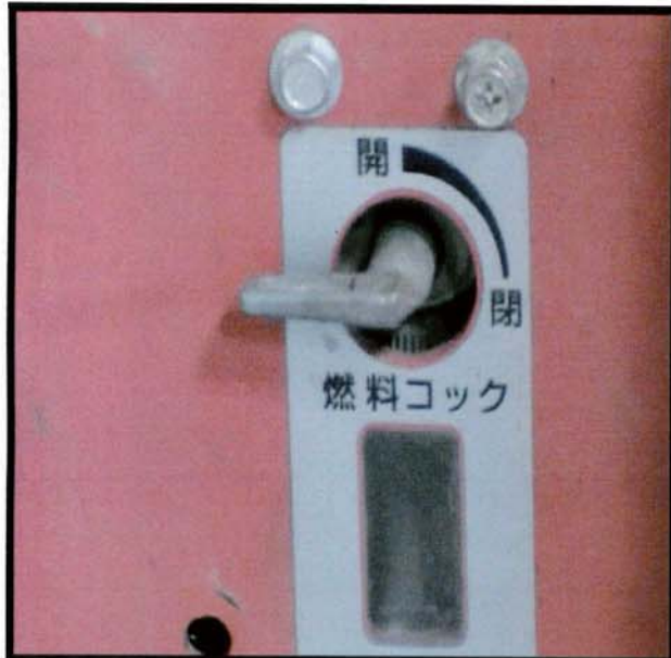
4. 発電機始動時ガソリンで1分間運転後 ガソリンコックを閉にしてガスに切り替える
